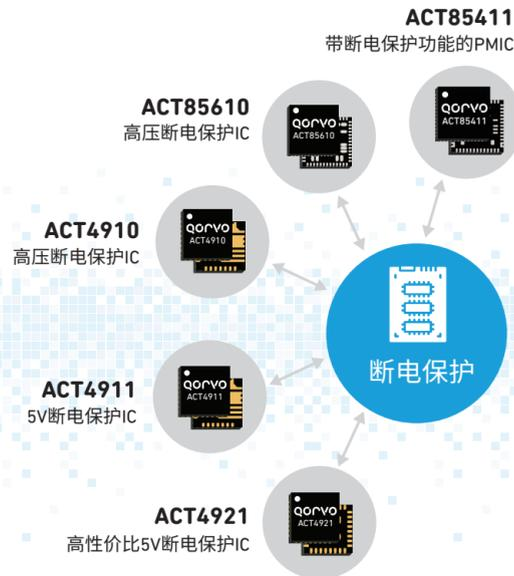
Qorvo的ACT系列PLP IC具有宽电压输入范围，通过高压电容来存储能量并生成随时可用的备用电源，从而提供高度集成的断电保护解决方案。这些PLP解决方案包括兼容热插拔的e-Fuse，可限制热插拔期间的浪涌电流，并支持平稳可靠的上电顺序。当主机电源或主输入电源断电时，利用高压电容上存储的备用能量为系统提供不间断电源。
